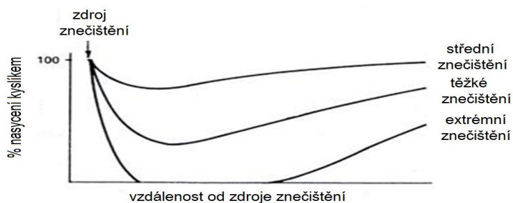
Obrázek 14. Obecná závislost nasycení vodního toku kyslíkem na vzdálenosti od zdroje znečištění (Švehláková a kol., 2006).
