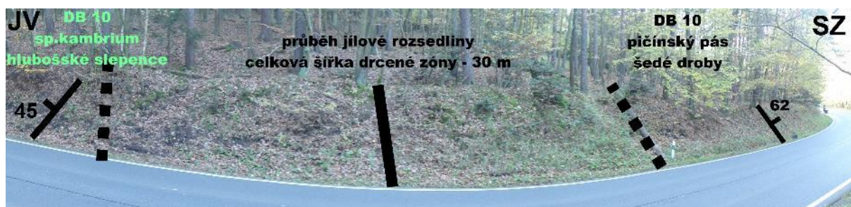
Obr. 7.5. Profil jílovou rozsedlinou v zářezu silnice č. 114 Dobříš – Hostomice.
