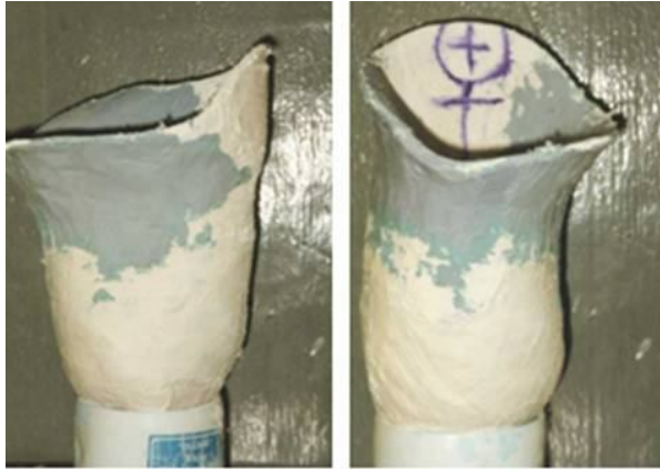
Obrázek 84: sádrové zkušební lůžko
