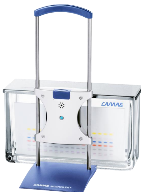
Obr. 6: SmartALERT pro monitorování čela mobilní fáze (1).
