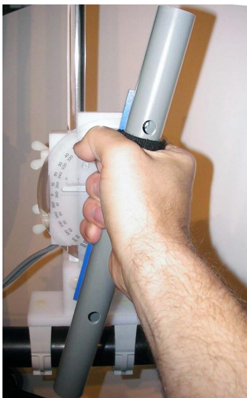
Obrázek 9. Zařízení na měření subjektivní haptické vertikály (Schuler et al., 2010).
