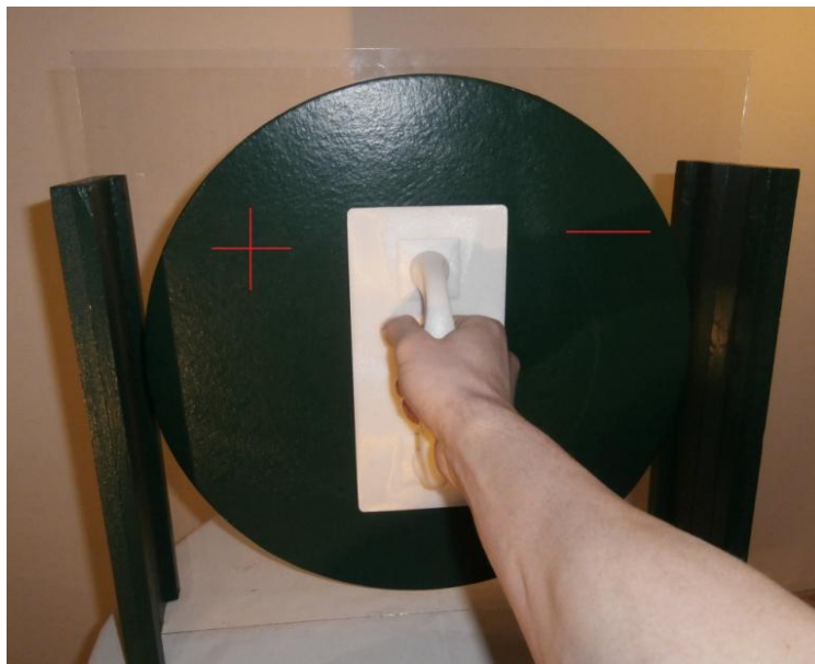
Obrázek 14. Správný úchop měřící tyče. Plusem je znázorněna odchylka protisměru hodinových ručiček, mínusem po směru hodinových ručiček.
