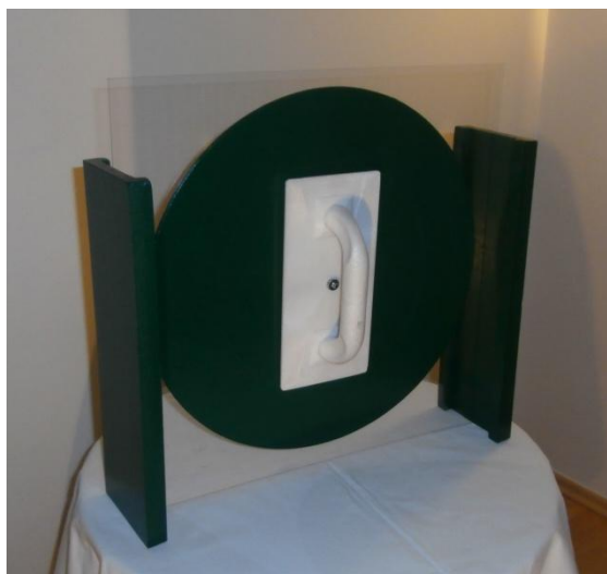
Obrázek 12. Strana vyšetřovaného s měřicí tyčí, která je propojena s úhloměrem.
