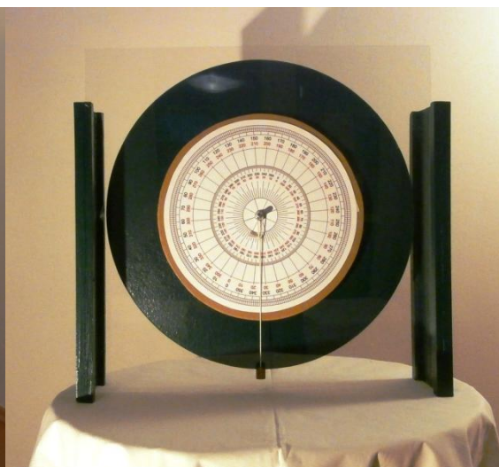
Obrázek 13. Strana vyšetřujícího s olovnicí a úhloměrem, které ukazují odchylku měřicí tyče od OV.
