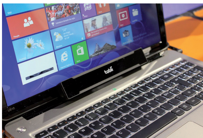
Obr. 24: Tobii Gaze při praktickém použití – umístěn pod displejem notebooku
