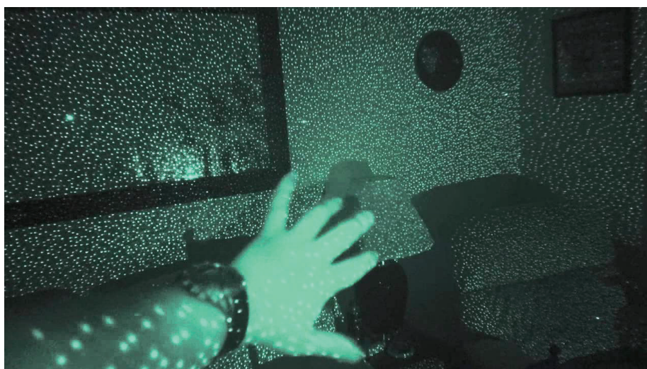
Obr. 6: Optická struktura, kterou vysílá zařízení (zde Kinect), přesněji jeho hloubkový infračervený senzor, ke zjištění hloubky jednotlivých bodů v obrazu. Snímek je získáný přes infračervený filtr na objektivu.
