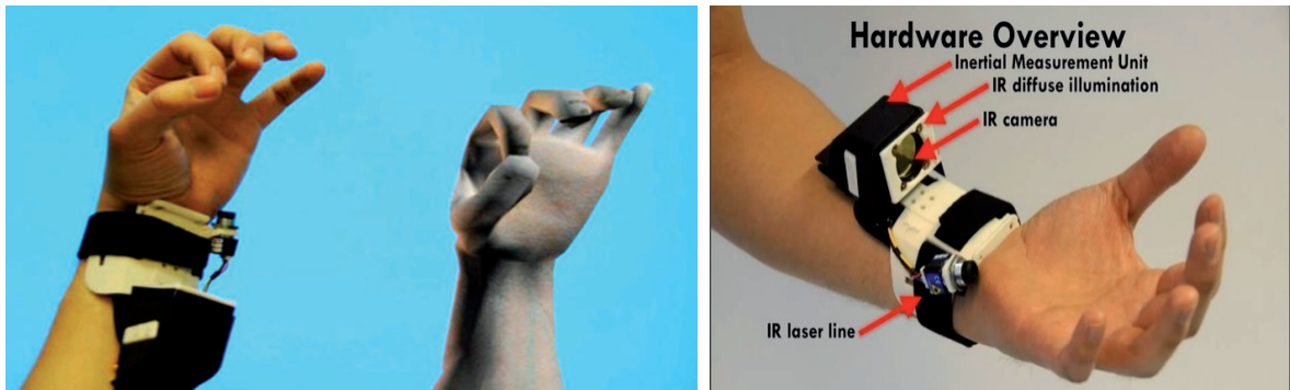
Obr. 21: Náramek Digits – vlevo gesto ruky a její nárámek nasmlínaná podoba, vpravo popis senzorů na nárámku
