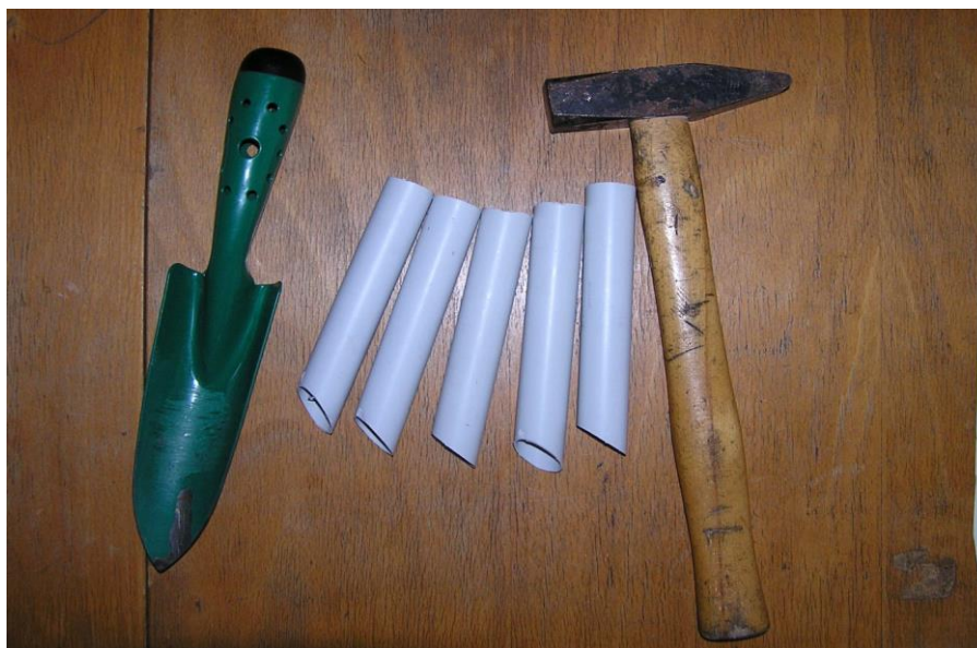
Obr. 3. 5 vzorkovačů (plastové tenkostěnné trubky o průměru 25mm a délce 15cm) připadajících na jednu lokalitu + kladivo a lopatka sloužící k zatlučení vzorků a odebrání vzorků zeminy.
