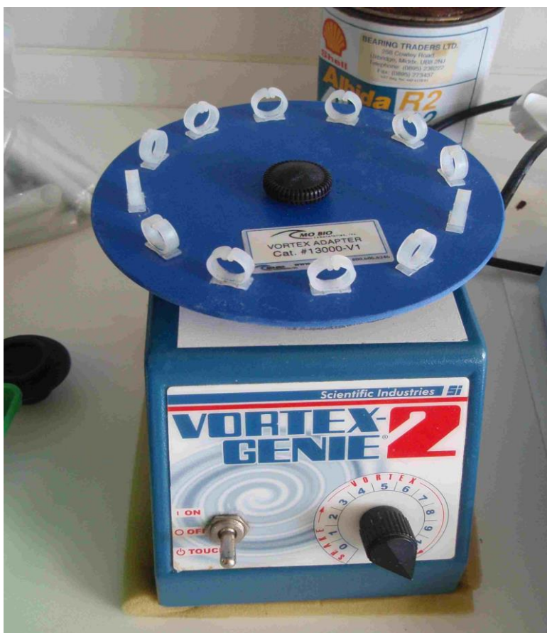
Příloha 1. Míchačka typu „Vortex“.
