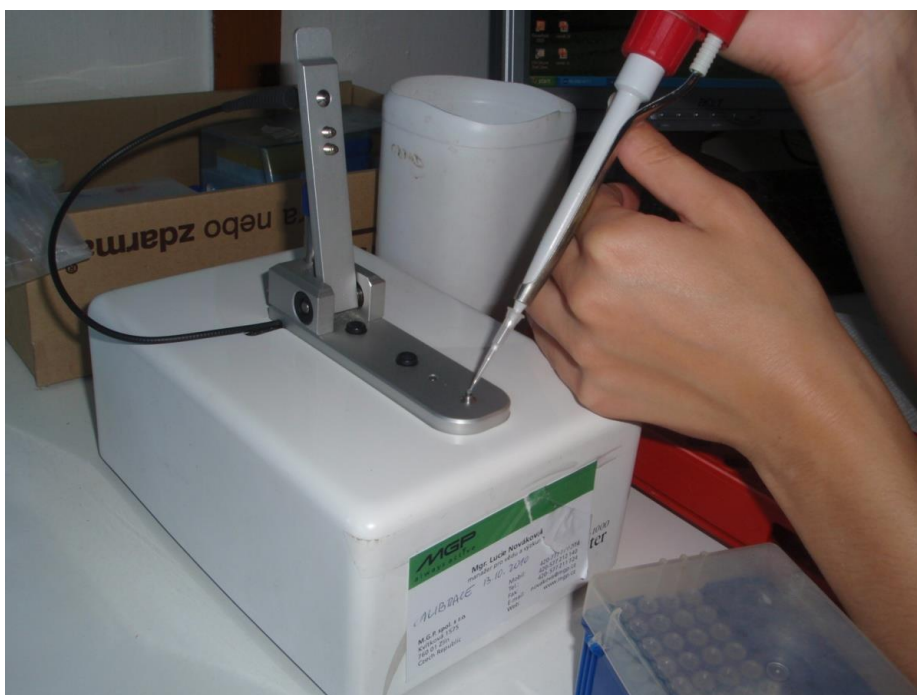
Příloha 2. Spektrofotometr „Nanodrop“ (Thermo Scientific).
