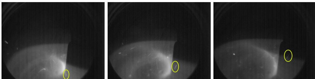
Obrázek 1.2: Fotografie 3 prachu detekovaného pomocí Fast VIS cameras v tokamaku Compass umístěném na ÚFP AV ČR.
