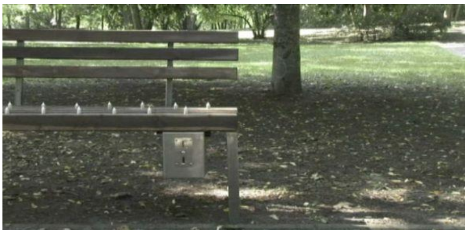
Obr. 4. Lavička s hroty – po vhození mince hroty zajedou a vy si můžete sednout. Naprosté nepochopení veřejného prostoru.
