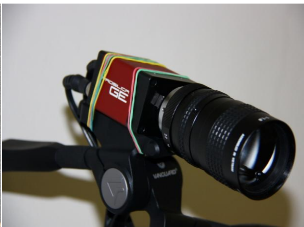
Obr. 35: Kamera s objektivem Pentax C31204TH
