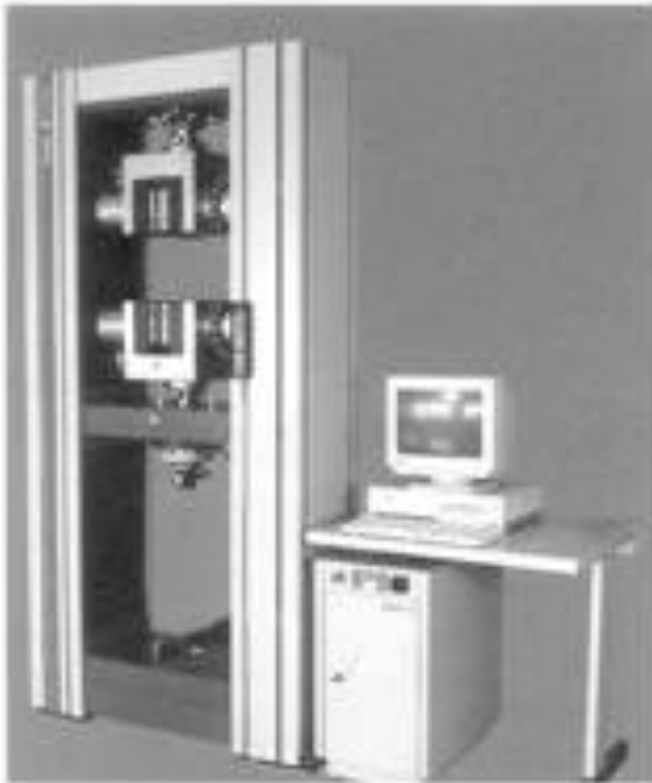
Obr. 5: Materiálový zkušební stroj T1-FR050TH.A1K firmy Zwick/Roell 23
