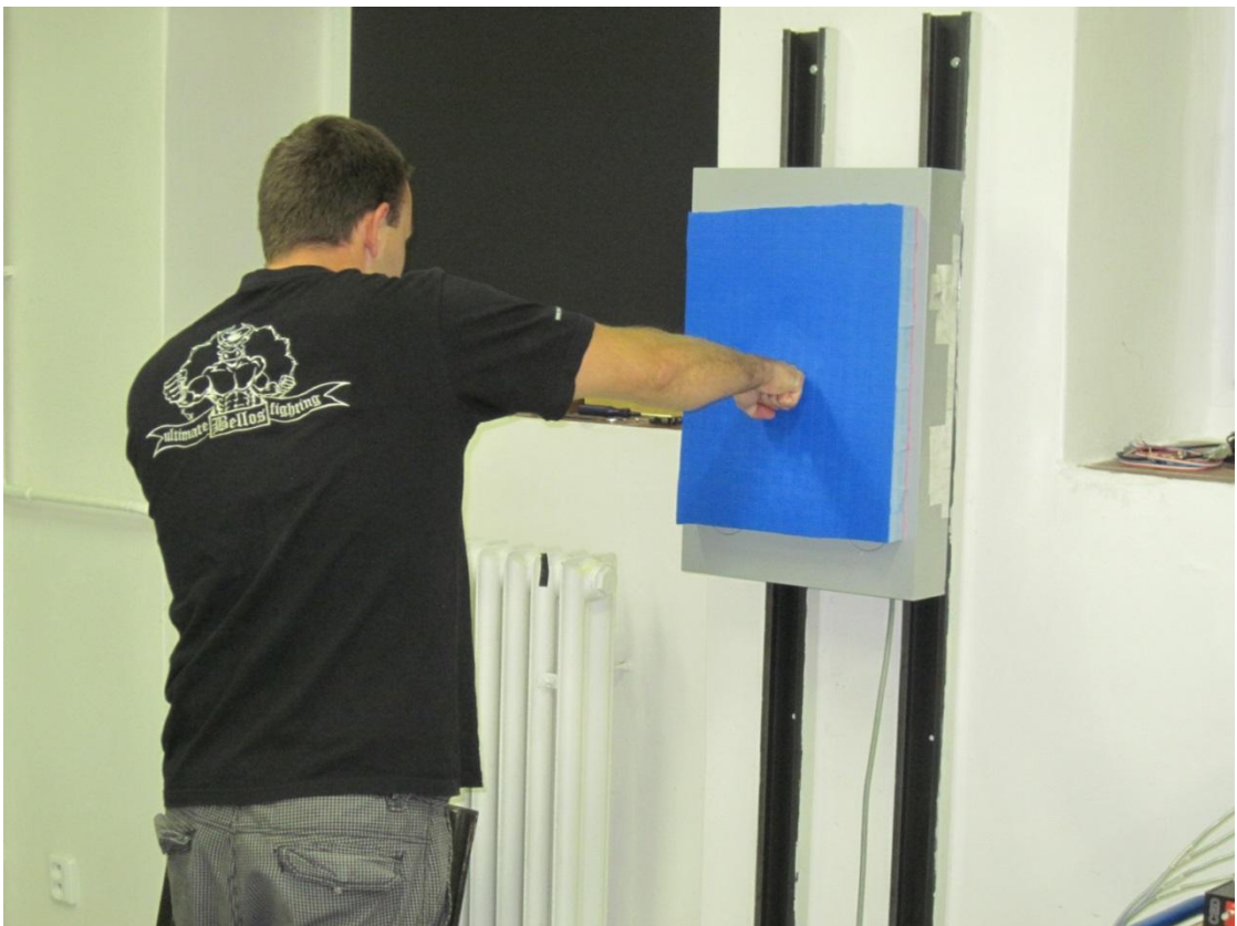
Obr. 6: ukázka přímého úderu do měřicí desky Kistler.
