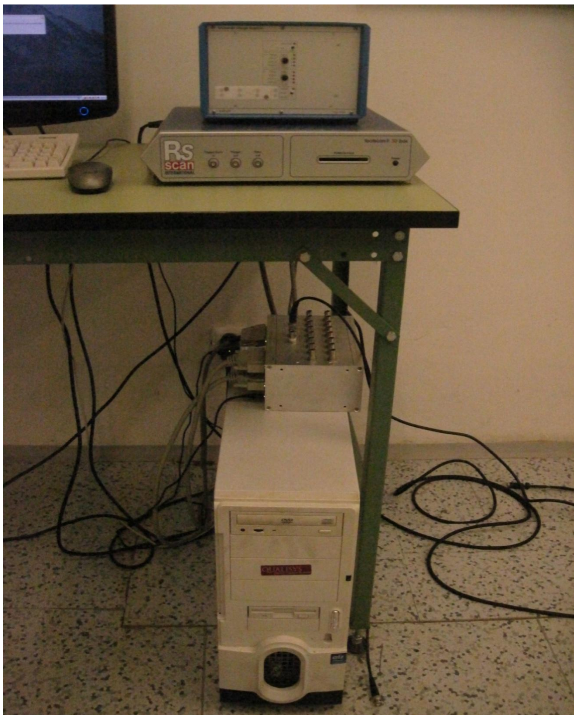
Příloha 20: Celkový pohled na kombinaci přístroje KISTLER – type 5606A a stolního počítače.
