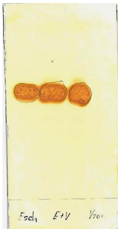
Obr. 10: TLC vzorku 1B a jeho porovnání se standardem escholtzinem v soustavě S3
