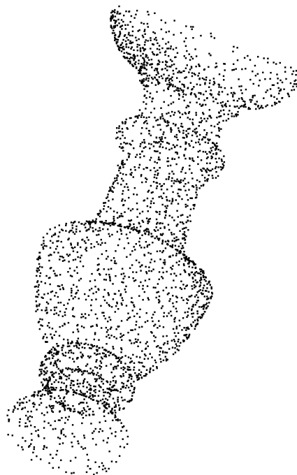
Obrázek 6.11: Bodová množina bez úprav reprezentující povrch balustrády tvořené sousými rotačními plochami – výstup z dotykového skeneru MicroScribe G2X
