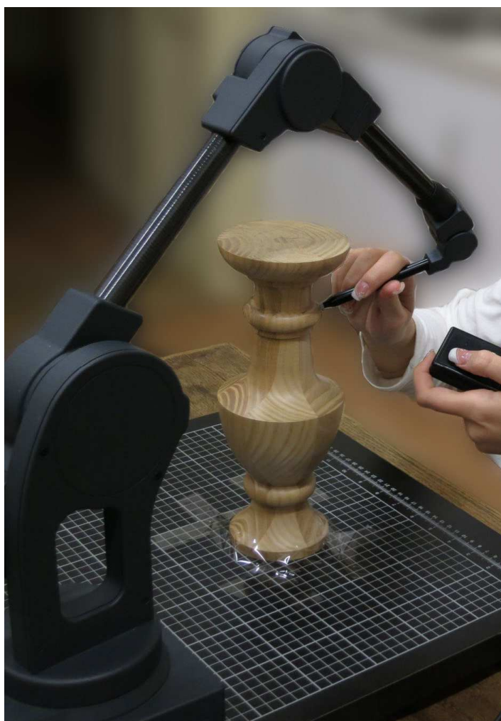
Obrázek 6.1: Dotykový skener MicroScribe G2X – zapůjčený na pracovišti Laboratoř 3D zobrazovacích a analytických metod, Katedra antropologie a genetiky člověka, Přírodovědecká fakulta UK v Praze
