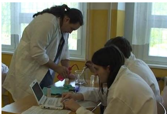
Obrázek 58 - Žáci sexty G-A: pH elektrodu je nutné mezi měřeními očistit
