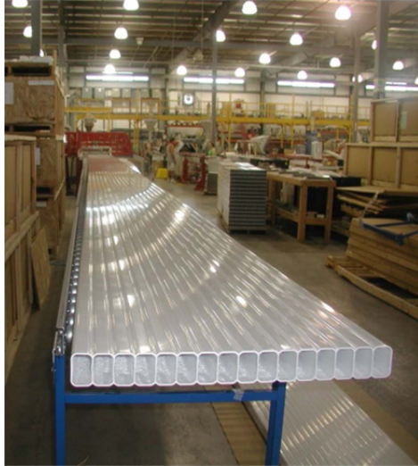
Obrázek 1.7: Vlevo: Extrusion je tvořený 16 celami. Vpravo: Uspořádání vrstev PVC cel v detektoru. Střídají se horizontálně a vertikálně uložené vrstvy [obrázek vlevo z 19],[obrázek vpravo z 21].
