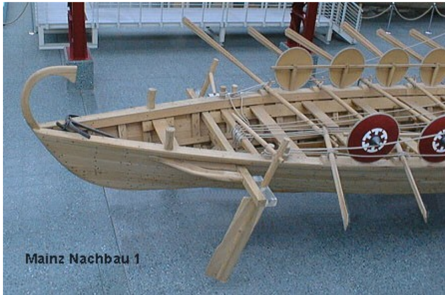
Obr.36 – rekonštrukcia kormidlového systému lode typu Mainz A
