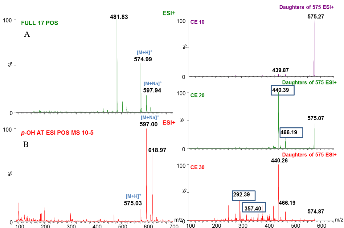
Obr. 62: Spektrum p -hydroxyatorvastatinu v pozitivním módu ESI – základní sken (A), přímá infuze (B) a výběr produktových iontů (kolizní energie CE = 10 V, 20 V, 30 V)
