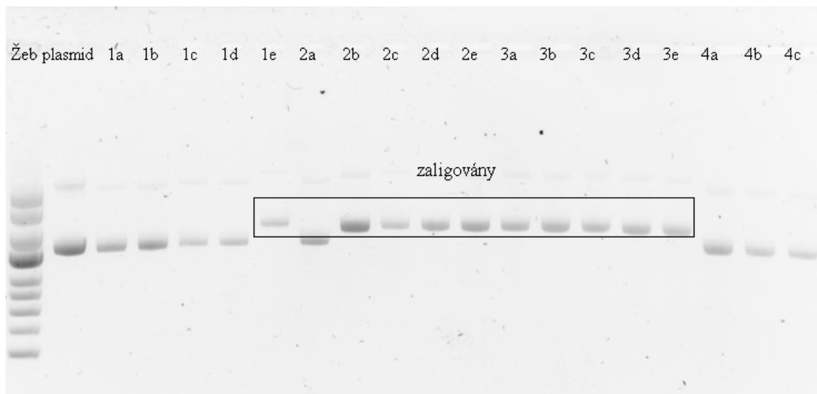
Obrázek 10: Elektroforetická analýza po ligaci a transformaci v podmínkách 0,8% agarósový gel, 90V 45 minut. Molekulový marker (Žeb) 2-log DNA, pro kontrolu nanesen plasmid pET28b(+) a vzorky. Vzorky 1a – 1d, 2a a 4a – 4c odpovídají velikostí prázdnému plasmidu. Ostatní vzorky (ve vyznačeném obdélníku) jsou větší velikosti a v nich proběhla ligace a transformace úspěšně.
