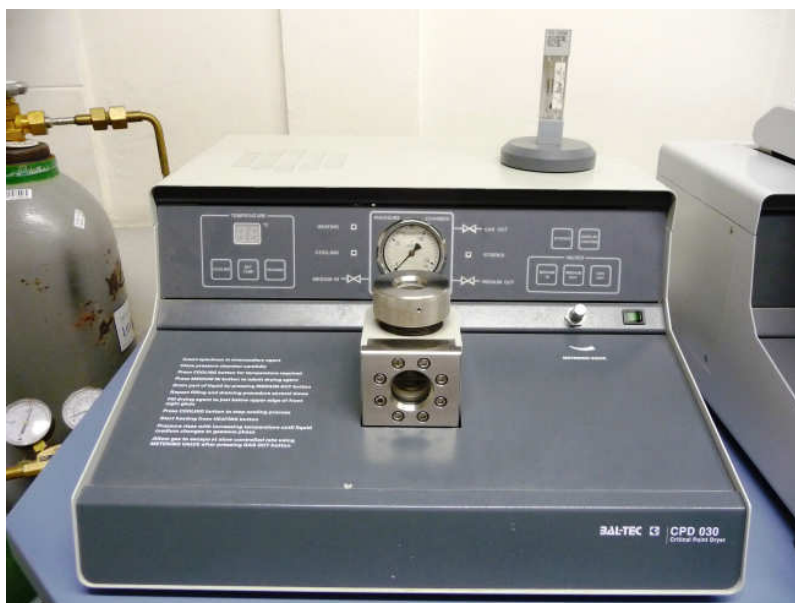
Obr. 4: Aparatura pro sušení metodou kritického bodu Bal-Tec CPD 030 v Laboratoři elektronové mikroskopie, Přírodovědecká fakulta UK v Praze. Foto Jana Dvořáková, 2013.
