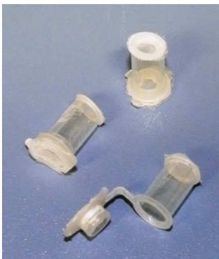
Obr. 3: Košíčky, ve kterých se vzorky odvodňují vzestupnou alkoholovou řadou a vkládají se do aparatury pro vysoušení. Foto Jana Dvořáková, 2013.
