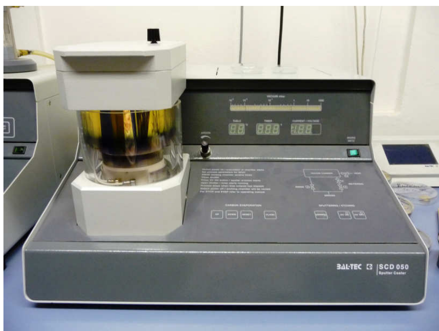
Obr. 5: Naprašovací zařízení Bal-Tec SCD 050 v Laboratoři elektronové mikroskopie, Přírodovědecká fakulta UK v Praze. Foto Jana Dvořáková, 2013.
