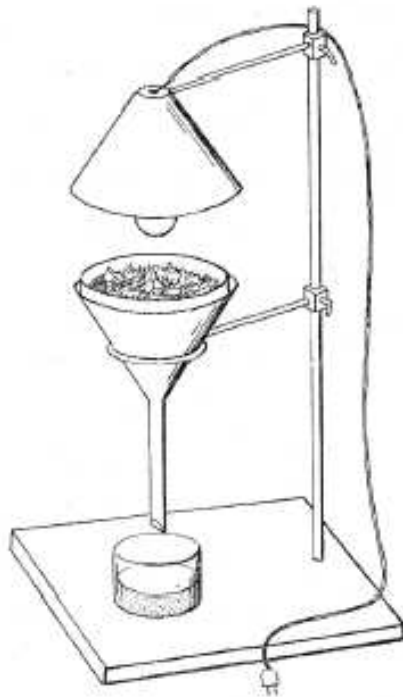
Obr. 2: Berlese – Tullgrenův extraktor, převzato z Winklera (1974).
