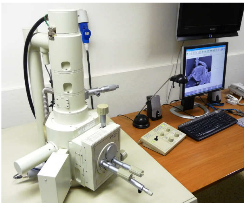
Obr. 7: Skenovací elektronový mikroskop JEOL 6380 LV v Laboratoři elektronové mikroskopie Přírodovědecká fakulta UK v Praze. Foto Jana Dvořáková, 2013.
