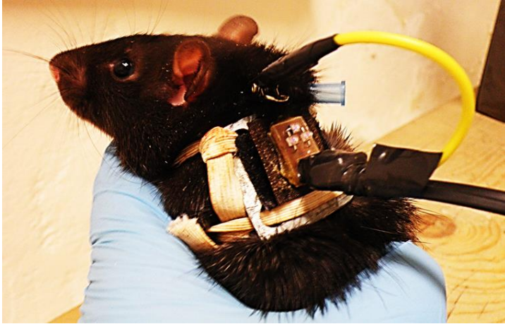
Obr. 4: Speciální postroj pro potkany, který obsahuje infračervenou LED-diodu pro snímání pohybu a polohy potkana kamerou. Jeho součástí je i kabel, který přivádí elektrický proud a je spojen pomocí svorky s injekční jehlou ve volné kůži za krkem potkana, čímž je zajištěno vodivé spojení s arénou, jež umožňuje dávat elektrické ranky.
