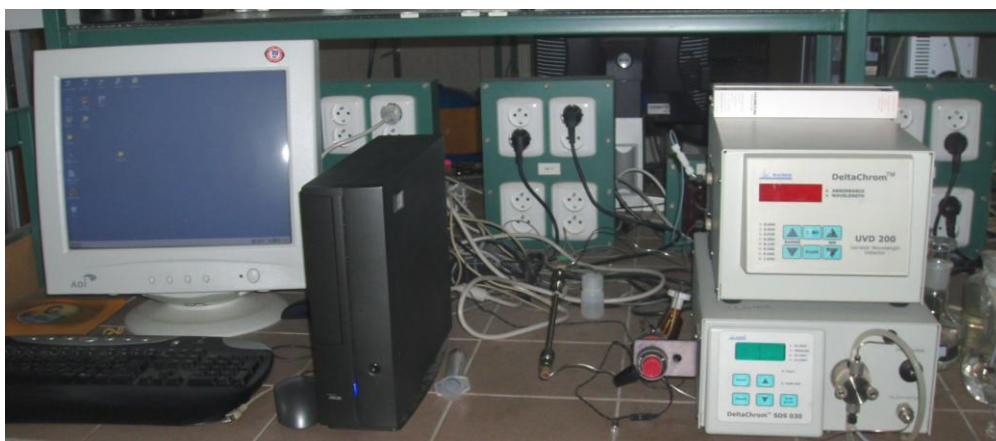
Obr.23: Celkové uspořádání čerpadla, kolony, detektoru a počítače.
