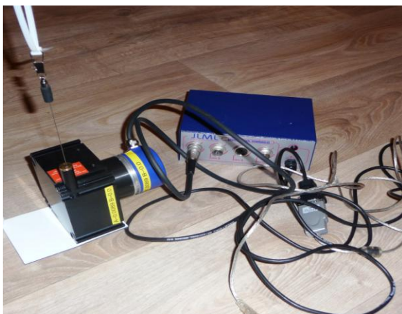
Obr. č. 1: Přístroj Isocontrol dinámico pro měření výbušné síly
