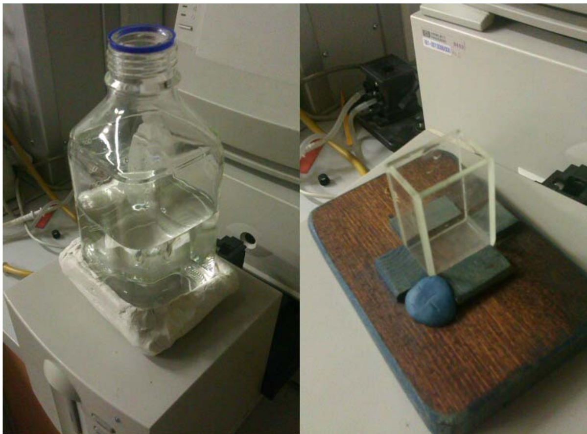
Obrázek 17: Kyvety pro měření vyšších objemů. Kyveta s optickou drahou 9 cm (vlevo). Kyveta s optickou drahou 3 cm (vpravo). Včetně stojánku k upevnění do přístroje.
