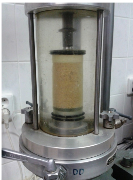
Obrázek č. 11 – Vzorek před smykáním (2012).
