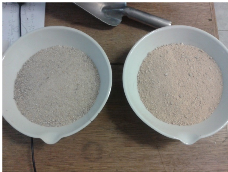
Obrázek č. 8 – Použité vzorky zeminy pro zrnitostní rozbor; vlevo zemina s chybějícími frakcemi < 0,063 \text{ mm} a > 3 \text{ mm} , vpravo původní zemina s obsahem obou frakcí (2013).
