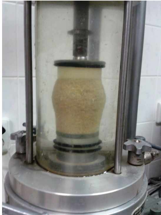
Obrázek č. 12 – Vzorek po smykání (2012).
