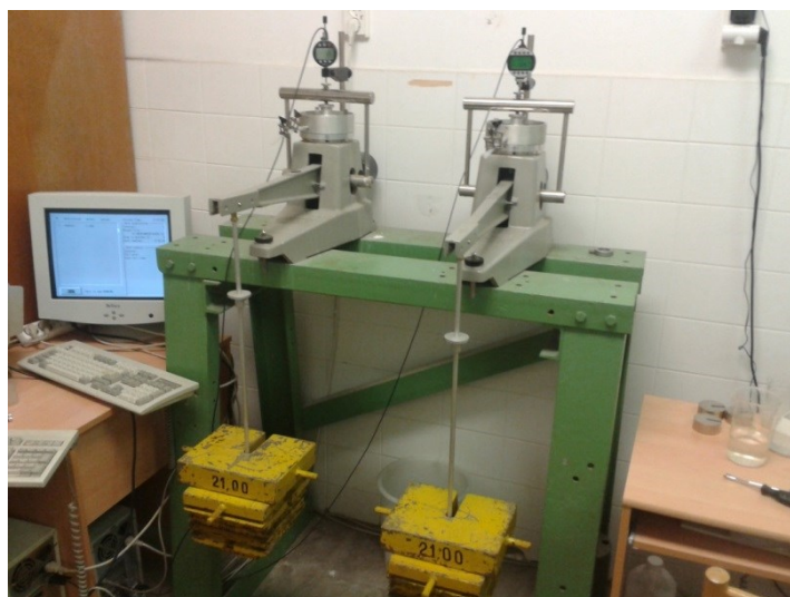
Obrázek č. 14 – Oedometrický přístroj při provádění oedometrických zkoušek (2013).
