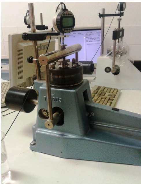
.Obrázek č. 13 – Použitý typ oedometrického přístroje (2013).
