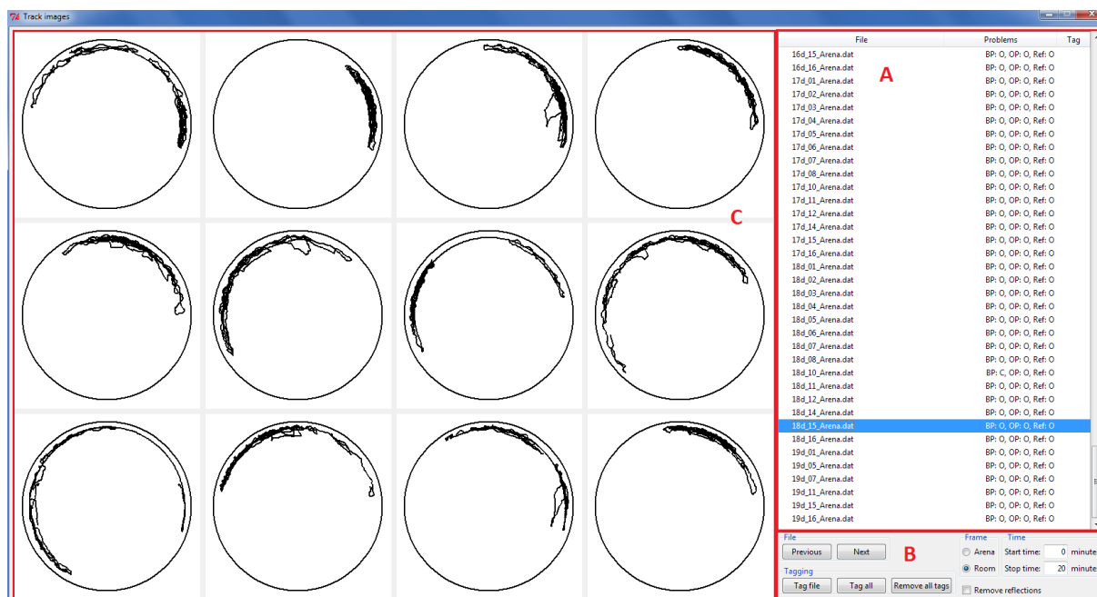
Obrázek 10: Kontrola záznamů v CM Manageru. A) Zobrazení souborů ve skladu souborů, informací o nalezených problémech a označení souborů. B) Označování souborů, výběr zobrazeného rámce, nastavení zobrazeného času, nastavení odstraňování odlesků. C) Zobrazená dráha z jednoho souboru a rámce. Data z nastaveného času jsou rozdělena mezi všechna plátna tak, že na každém je zobrazen stejně dlouhý časový interval (v sekvenci po řadách, zleva doprava). Toto zobrazení umožňuje snadnější identifikaci odlesků či jiných problémů.
