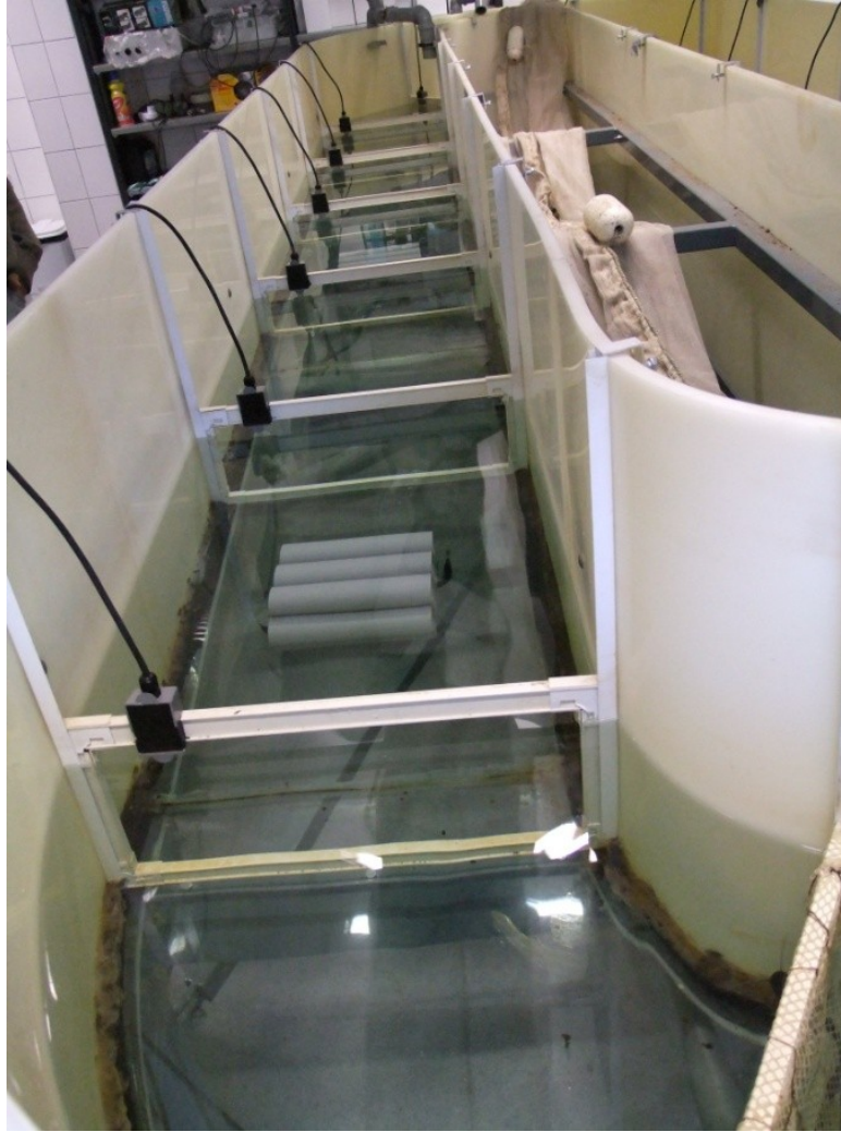
Obrázek 5: Pokusná část žlabu
