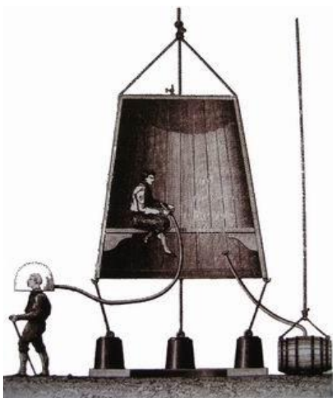
obrázek č. 4 – konstrukce potápěčských zvonů dle Edmunda Halleye s přívodem vzduchu – 1690, zdroj: http://www.profimedia.cz/fotografie/historicka-rytina-potapecsky-zvon-design-od-1691/0010138316/
