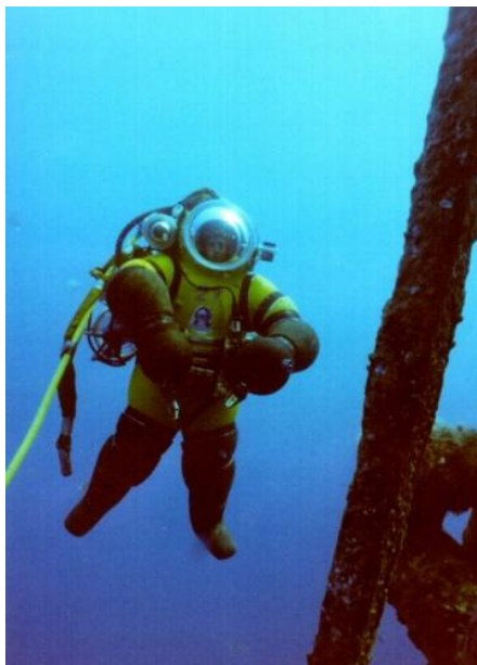
obrázek č. 9 – oblek JIM vyráběný britskou firmou Underwater and Marine Equipment – 1979, zdroj: http://www.judojim.com/wst_page4.html
