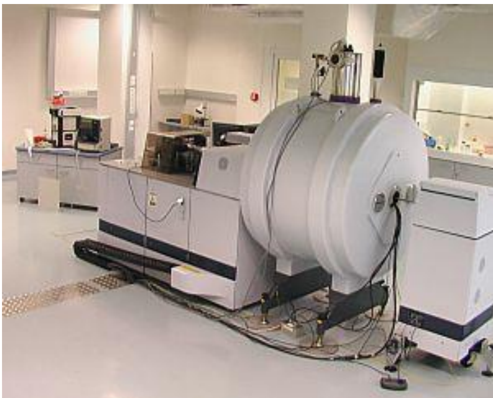
Obr. 5.5: ESI-FT-ICR hmotnostní spektrometr (9.4T APEX-Ultra, Bruker Daltonics, USA), fotografie stažena z webových stránek http://ms.biomed.cas.cz/equipment.php .
