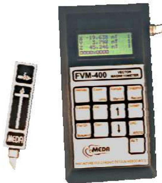
Obr. 23 Fluxgate vektorový magnetometr (Meda, 2000)
