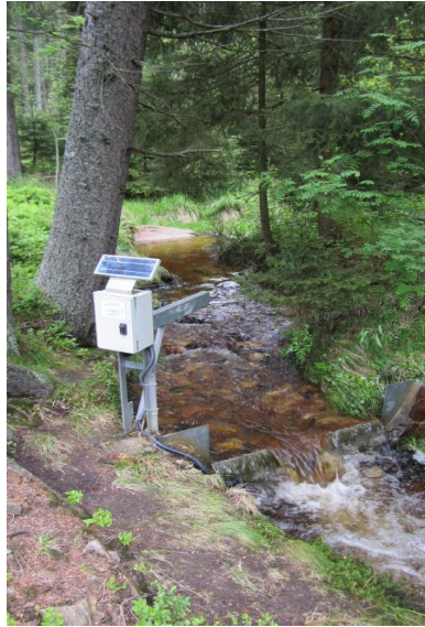
Obr. 6. Profil na Tetřívčím potoce s měrným přelivem a hladinoměrem
