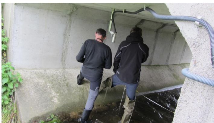
Obr. 8. Měření průtoku hydrometrickou vrtulí na Sviňovickém potoce
