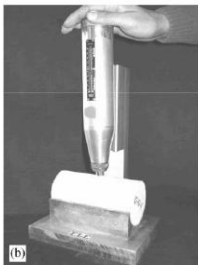
Obr. 2. Práce se Schmidtovým kladivem: a) v podmínkách in situ , b) v laboratorních podmínkách (převzato z Göktana a Gunese 2005).
