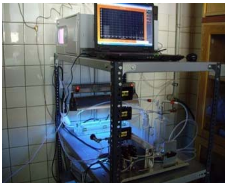
Obr. 3.8: Sestavená aparatura pro fotokatalytické testování \text{TiO}_2 pro odbourávání \text{NO}_x 16
