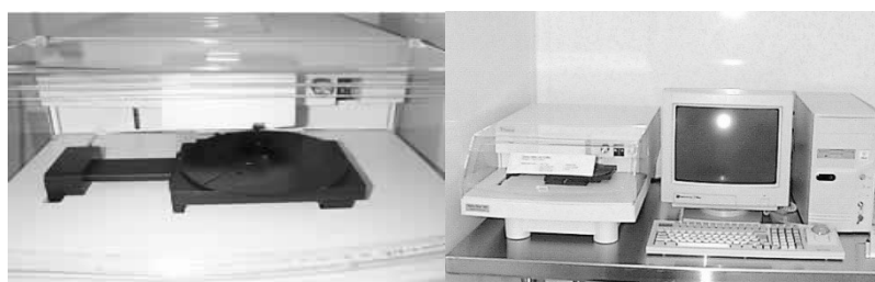
Obr. 3.2: Profilometr Tencor Alpha-Step 500 29
