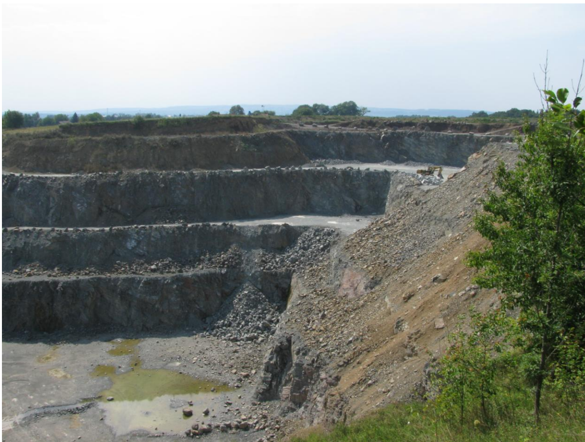
Obr. 7. Celkový pohled na S-Z část lomu. Vpravo nahoře těžba 4. etáže. Vpravo dole zavážení etáží skryvkou.
