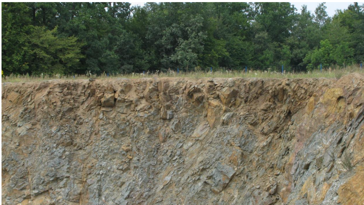
Obr. 3. Navětralý horizont v S-V části lomu, oxidy železa barví přípovrchovou partii do rezavé barvy.
