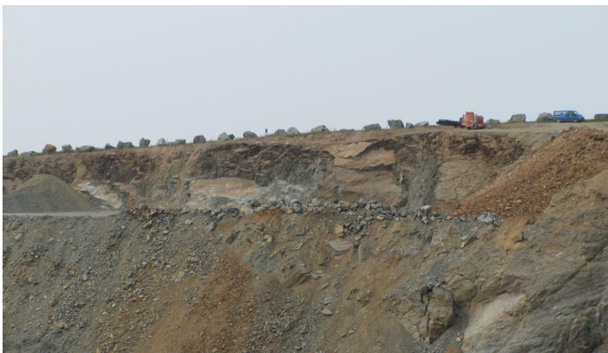
Obr. 6. Nejvyšší etáž v S-Z části lomu, při povrchu je vidět navětralá hornina (14. 8. 2011).
