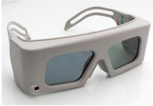
Obr. 8 Bezdrátové stereoskopické brýle NuVision 60GX (Převzato z: Shop.gali-3d.com, c2010)
