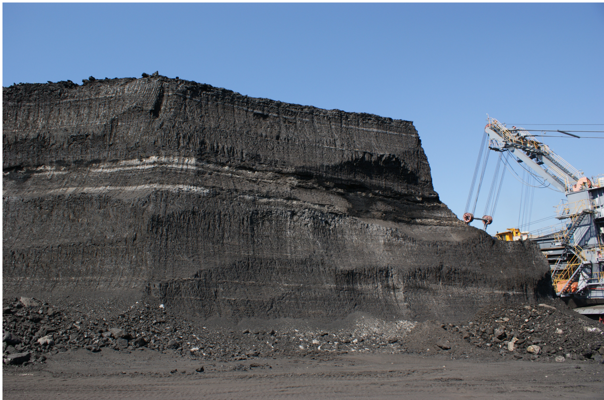
Obr. 8. Hlavní hnědouhelná sloj s třetinovým proplástkem v lomu Bílina – holešické vrstvy mosteckého souvrství. Foto : autor
