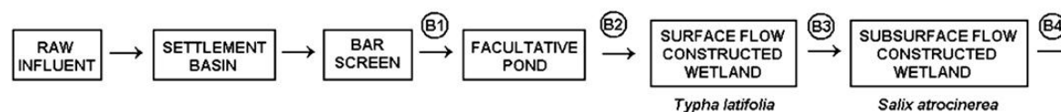
Obr. 1 Diagram kořenových čistíren v severovýchodním Španělsku. Místa odběru vzorků jsou vyznačena v kroužku (Hijosa-Valsero et al., 2010a).
