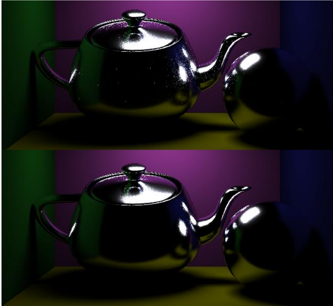
Obrázok 15: V oboch prípadoch použitá distribučná funkcia mikroplošiek GGX. Hore vzorkovanie normály prispôsobené pre GGX – rovnica (4.13), dole vzorkovanie prispôsobené pre Beckmannovu distribučnú funkciu mikroplošiek – rovnica (4.14) (zdroj: autor).
