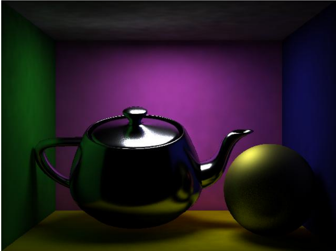
Obrázok 20: Demonštrácia vplyvu odstránenia výpočtu spekulárnej BRDF pri vyhodnocovaní sekundárnych lúčov. Výsledok pred odstránením je na Obrázok 19 (zdroj: autor).
