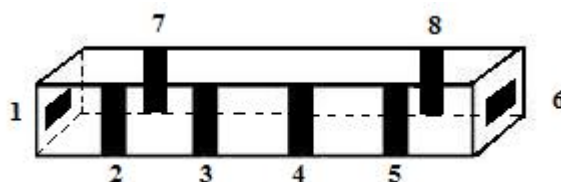
Obr. 4.1: Schéma nakontaktování vzorku E35A2B pro změření měrného odporu po elektromigraci
