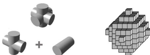
Obr. 2: CSG a Dekompoziční reprezentace.
