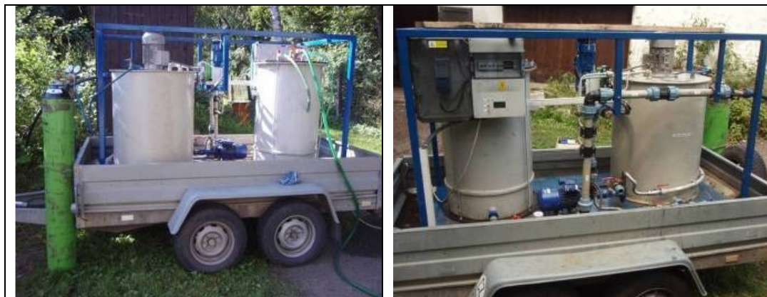
Obrázek 20: Aplikační zařízení pro injektáž nanoželeza a stopovačů.
