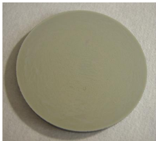
Obr. 11d. Homogenizace zeleného bentonitu a umístění na Si bezdifrakční nosič.
