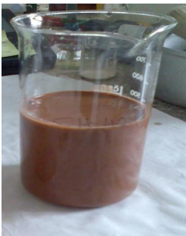
Obr. 11b. Bentonit ve skleněné kádince.
