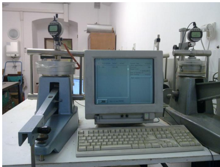
Obr. 12. Oedometr od firmy Wykeham Farrance, na němž proběhlo měření studovaných vzorků kyperských bentonitů.
