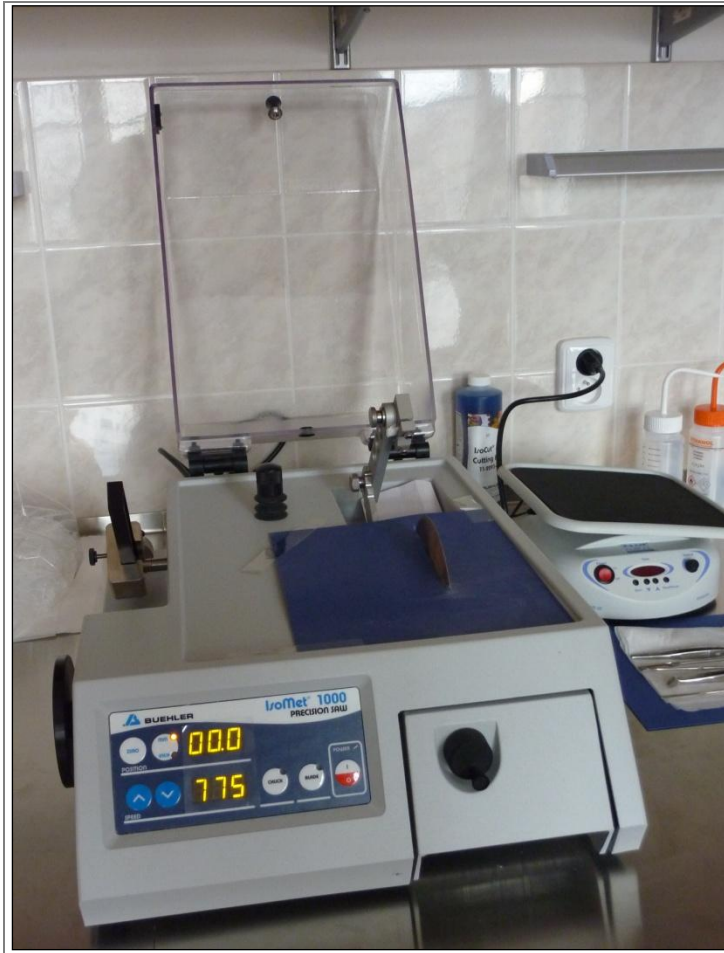
Obr. 8: Pila s diamantovým kotoučem IsoMet 1000 (Buehler Ltd.).
