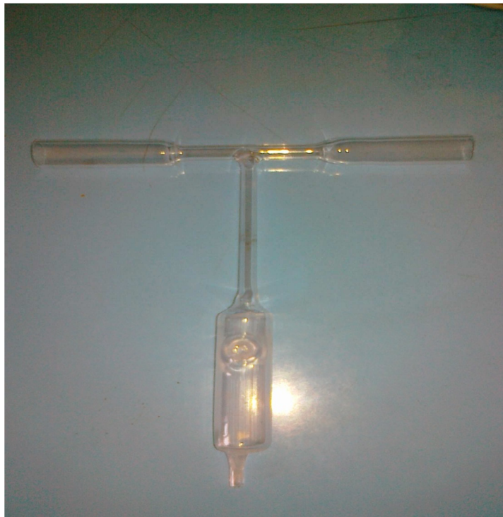
Obr. 3.1 Křemenný atomizátor se separátorem fází s nuceným odtahem
