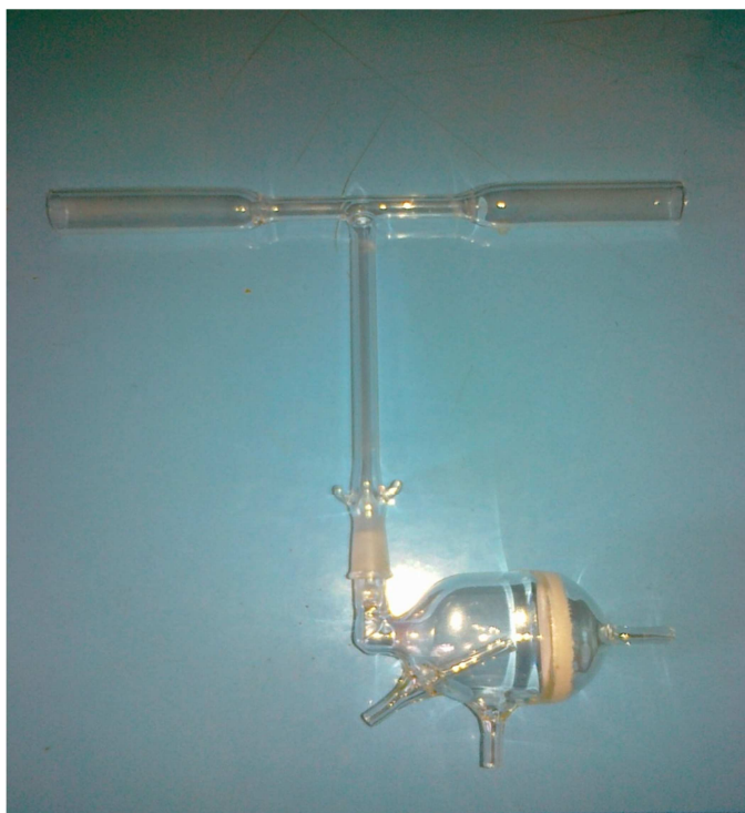
Obr. 3.2 Křemenný atomizátor se separátorem fází s nuceným odtahem a s fritou
