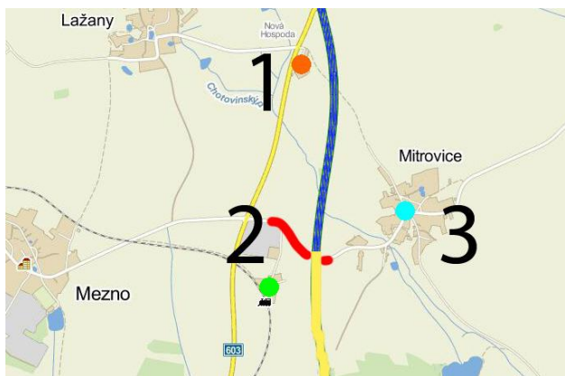
OBRÁZEK 23: MÍSTA MĚŘENÍ HLADINY PODZEMNÍ VODY. 1 – NOVÁ HOSPODA, 2 – MEZNO - NÁDRAŽÍ, 3 – MITROVICE. MODŘE JE VYZNAČEN HLOUBENÝ ZÁŘEZ D3., ČERVENĚ ZÁŘEZ PŘELOŽENÉ SILNICE III/1248. DLE JÄGERA, KESSLA, (2008), UPRAVENO Z WWW.MAPY.CZ
