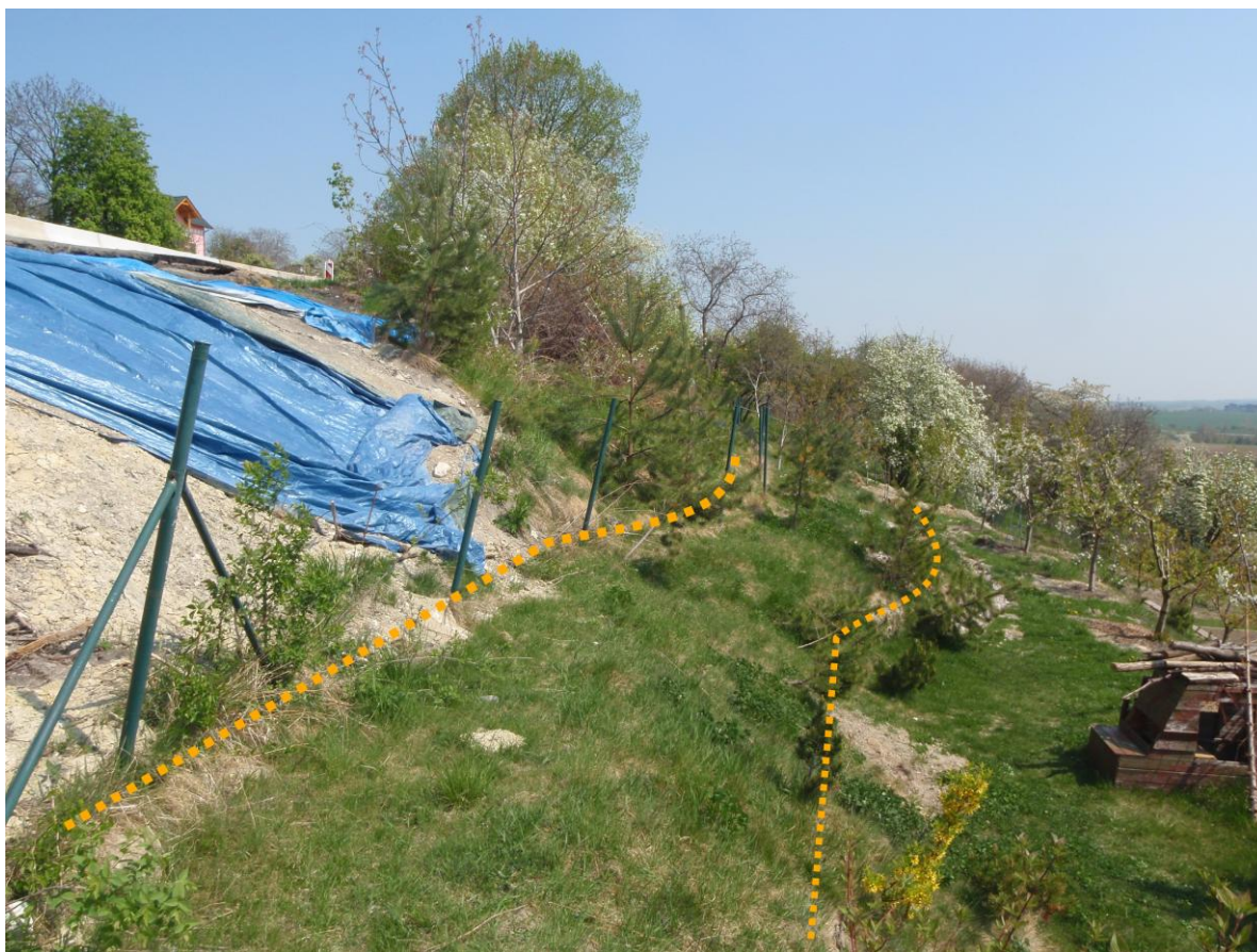
OBRÁZEK 74: POHLED NA AKUMULAČNÍ OBLAST SESUVU Z 19.4.2011 . TEČKOVANĚ JSOU ZVÝRAZNĚNY LINIE ZAHRADNÍCH SLOUPŮ A HRANICE DÍLČÍ LAVIČKY, KTERÉ DLE MAJITELE ZAHRADY BYLY PŮVODNĚ PŘÍMÉ.
