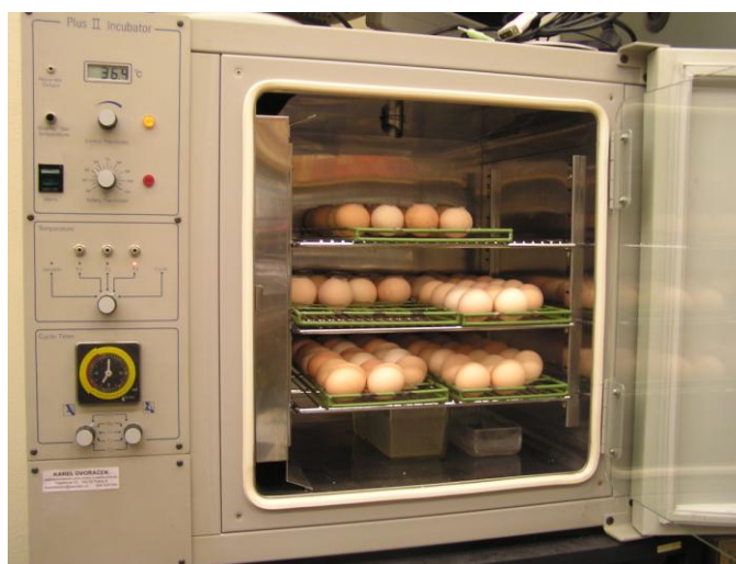
Obr. 9. Gallenkamp Plus II Incubator s násadovými vejci na nosných mřížkách.
