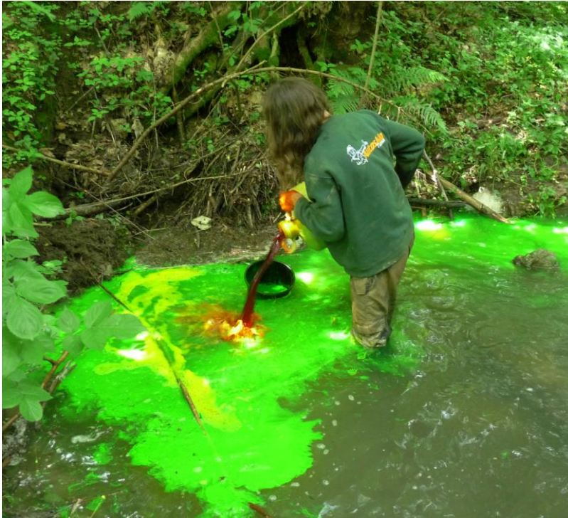
Obrázek 4.12 Injektáž fluoresceinu do Hádeckého propadání dne 7.6.2010 (foto I. Kůrková)
