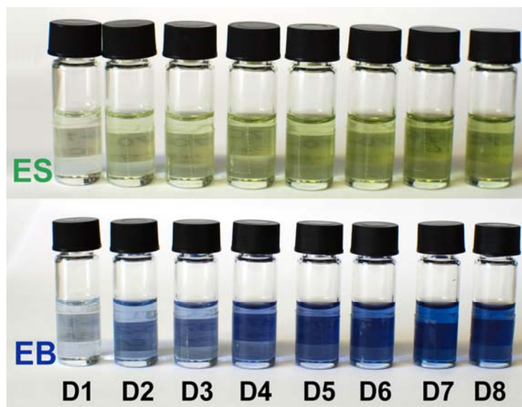
Obr. 8: Fotografie protonizovaných (ES) a bazických (EB) forem vzorků D1 až D8 . Podmínky přípravy viz obr. 7.
