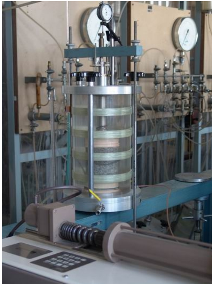
Obr. 10: Laboratorní vzorek v trojosé komoře
