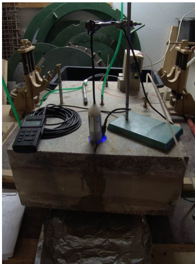
Obr. 14: Konfigurace stopovací zkoušky na bloku HR-2 (v pozadí peristaltická pumpa a vtláčecí vrt, uprostřed injekční vrt, v popředí jímací vrt s televizní kamerou a sondou konduktometru)
