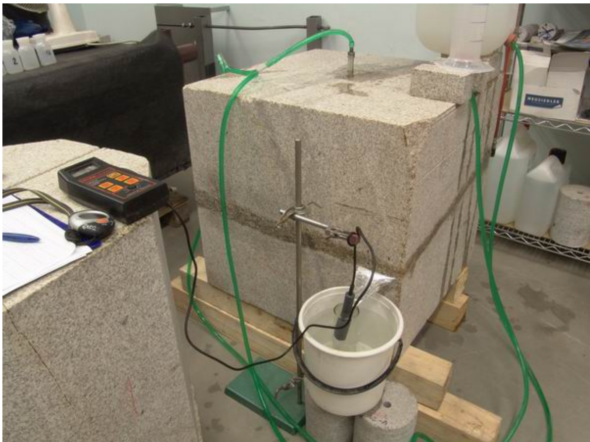
Obr. 13: Konfigurace stopovací zkoušky na bloku A-I-K-PV (v pozadí Boyle-Mariottovy lahve s destilovanou vodou a roztokem stopovače, uprostřed vtláčečí vrt, v popředí přepad nezatěsněné části pukliny a sonda konduktometru v jímací baňce)
