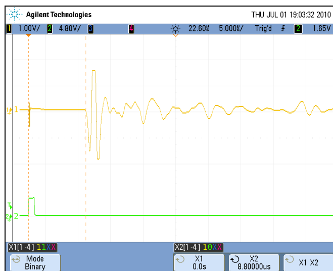
Obr. 77: Záznam času příchodu P-vlny na obrazovce osciloskopu
