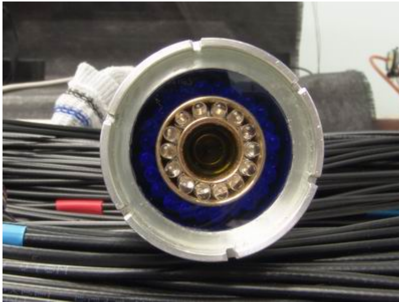
Obr. 17. Televizní kamera umožňující detekci fluoresceinu
