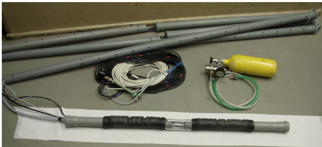
Obr. 37: Pakr s koncovou částí na bílém podkladě, tlakovou lahví sloužící k plnění vaků a kabeláží od televizní kamery a tlakového čidla.
